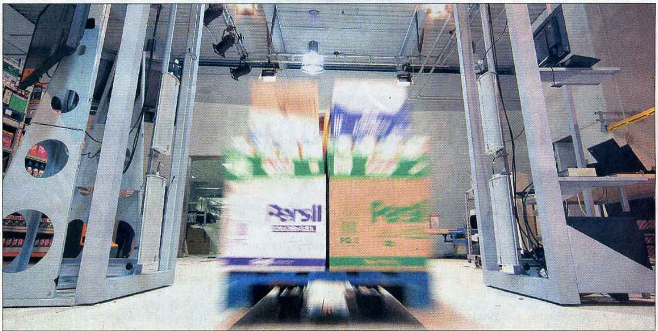
RFID-Leser im Lager: Die Lesegeräte erfassen beim Passieren vollautomatisch und blitzartig die Inhalte der Transportbehälter.
