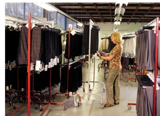
Nicht nur bei der Kommissionierung, sondern auch bei der Inventur beschleunigt die automatische Erfassung per Handleser die Prozesse. Dabei können Barcode und RFID-Tag gleichzeitig gelesen werden.
